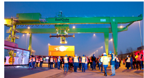
Im Rahmen des Logistiksymposiums 2014 konnten die Teilnehmer im Anschluss an die Konferenz auch die neue Kranbahn am KV-Terminal Frankfurt (Oder) besichtigen. Der Gigant kann 41 Tonnen gleisübergreifend über den 640 Meter langen Umschlagplatz bewegen. (Foto: Kuhnert Medien)
