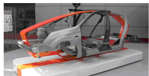
Der Stahlkonzern ArcelorMittal produziert am Standort Eisenhüttenstadt unter anderem hochwertige Bleche für die Autoindustrie und arbeitet an innovativen Prozessen. „S-in motion“ ist ein neues Konzept für Autohersteller, die leichtere, sicherere und umweltfreundlichere Fahrzeuge für das 21. Jahrhundert bauen wollen. (Foto: ArcelorMittal)
